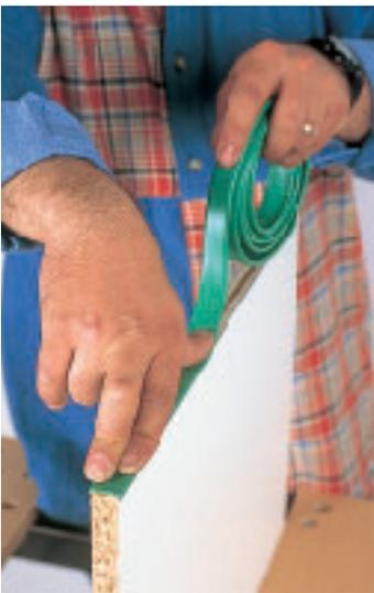
1. Déposer sur le chant et à l'intérieur de la bordure une mince couche de colle néoprène.
